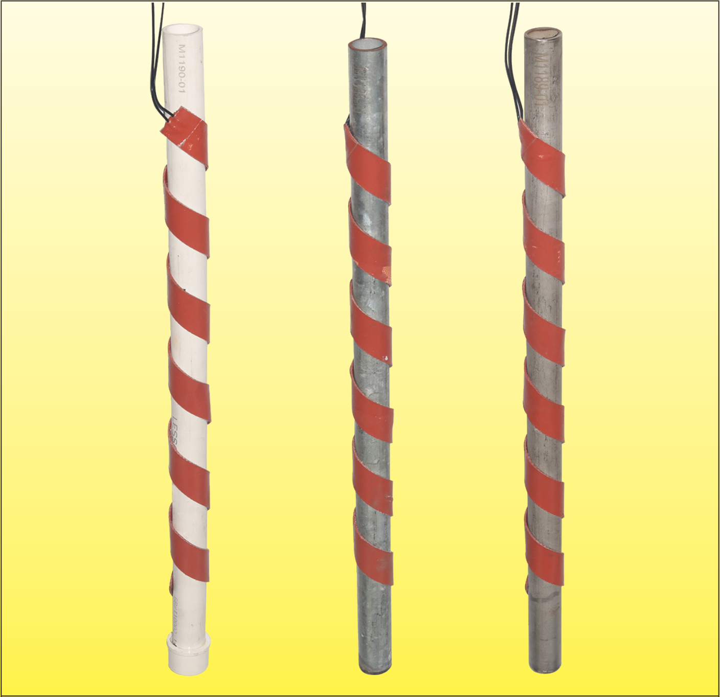
Condiciones de las pruebas comparativas: Cintas calefactoras de silicona enrolladas en tubos de diámetro externo de 25 mm, en PVC-U, acero galvanizado y acero inoxidable.
